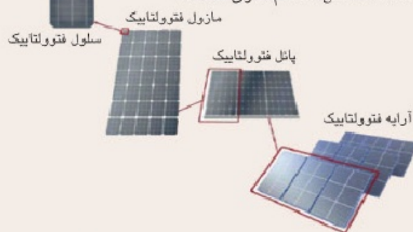
شکل ۴. اجزای سیستم سلولهای نوری (فتوولتائیک)
