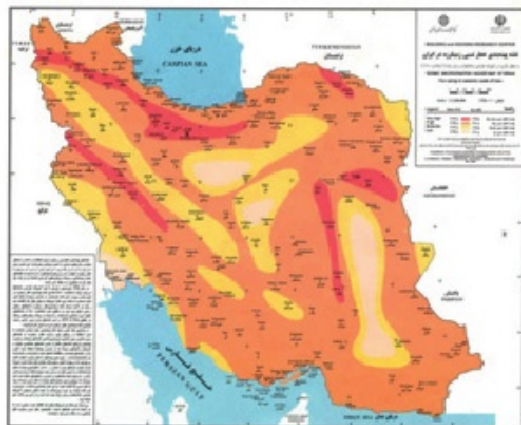
حداکثر شتاب زمین برای احتمال وقوع بیشتر از 2٪ در 50 سال و با دوره بازگشت 75 سال در ایران
