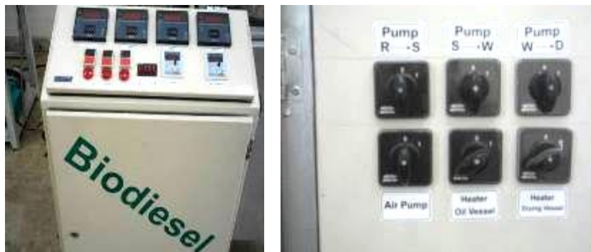
شکل ۲-۱: سیستم کنترل دستگاه نیمه پیوسته تولید بیودیزل
